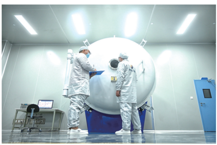
重庆开拓卫星科技有限公司工作人员正在进行太阳能电池片真空实验。
