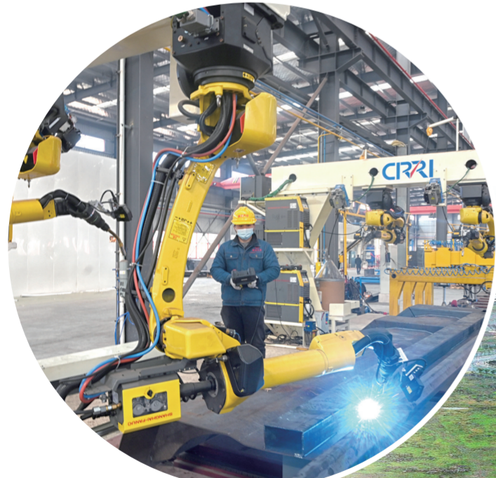
▲展亮汽车二期智能化机器人焊接生产线生产中。
