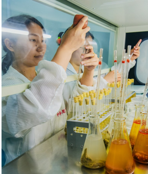
工作人员在实验室进行菌落总数检测。
