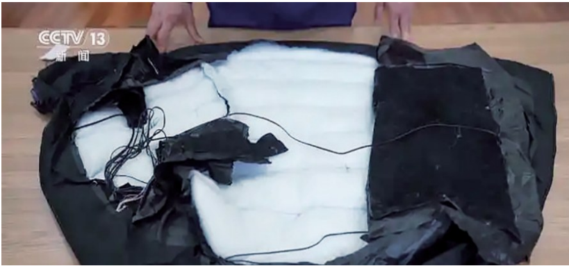
▲网络上的「电加热衣」琳琅满目。 ▲电加热衣线路布设比较混乱。
