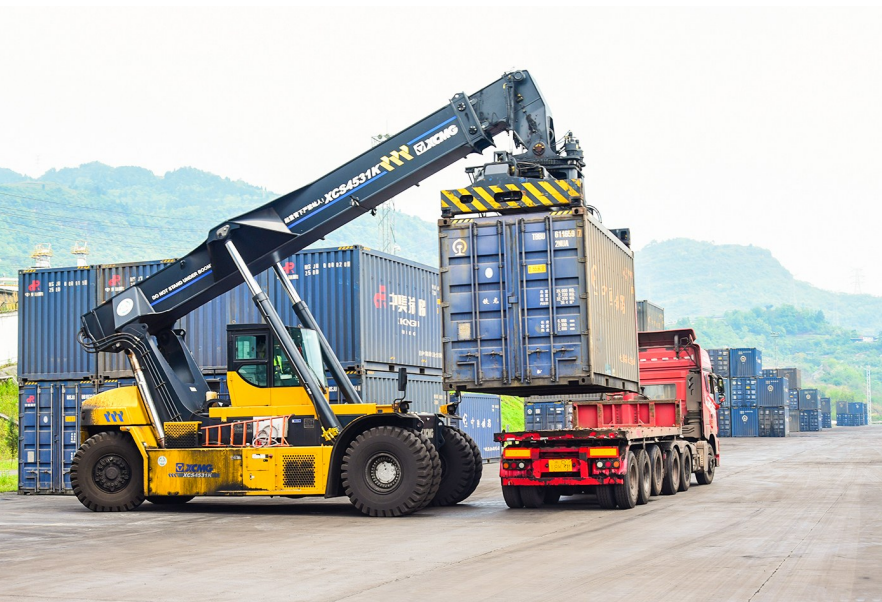
正面吊运机在吊运集装箱。记者 杨晨 摄
