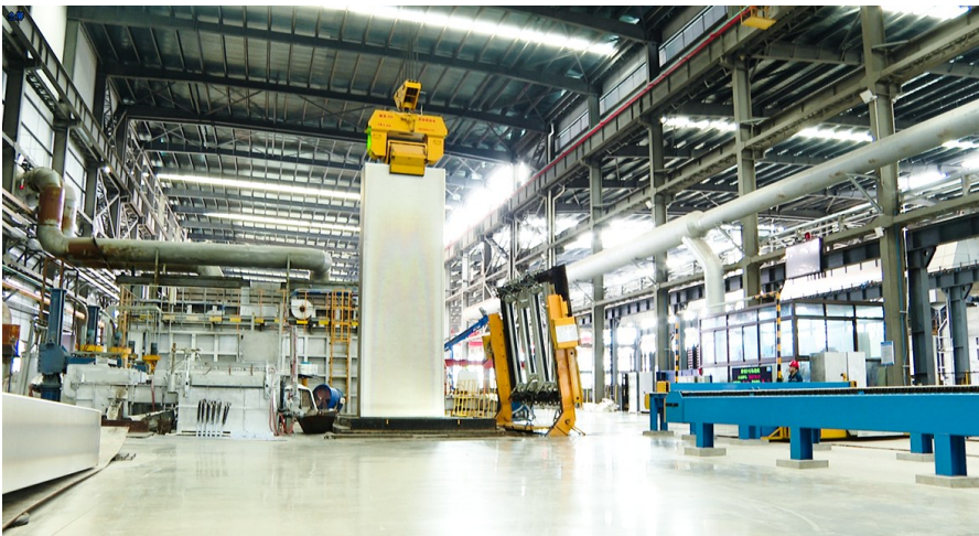
近日,重庆綦创再生资源利用有限公司生产车间内,专用吊具吊出刚完成铸造的大规格再生铝扁锭。
